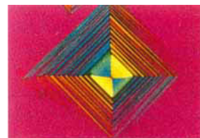
Abb. 25. Gestuftes Plättchen von DCDNB (Diagonale: 0.24 mm, Dicke am Rand des hellen Quadrats im Zentrum: 0.024 mm). Das Plättchen wurde innerhalb von 5 min durch Verdampfen von CHCl 3 erhalten; die Aufnahme entstand in [001]-Richtung mit gekreuzten Polarisatoren und einem Rot-Filter (γ = 45°). In diesem Einkristall entstehen die Sektoren durch nichtstatistische Orientierungsfehlordnung eines Chlor- und eines Nitrosubstituenten.
