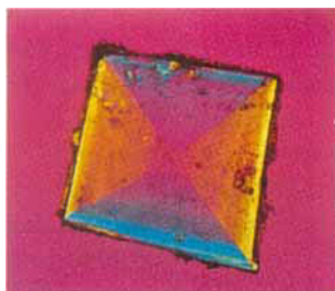
Abb. 2. Der Aufbau eines Mischkristalls aus Bis(11-bromundecanoyl)peroxid und 15 % der analogen Verbindung, bei der eines der endständigen Bromatome durch ein Wasserstoffatom ersetzt ist, aus Sektoren. Die Aufnahme erfolgte entlang der [001]-Richtung durch gekreuzte Polarisatoren mit einem Violett-Filter ( \gamma = 45^\circ ) [5]. Die Farbunterschiede zwischen den Sektoren beruhen auf der unterschiedlichen räumlichen Ausrichtung der Monobromverbindung, die durch die kinetische Kontrolle der Molekülanlagerung an die Seitenflächen bedingt ist. Das Bild stammt aus Lit. [5]. Dort wurde irrtümlich angegeben, daß die Verunreinigung statt des endständigen Bromatoms eine Methylgruppe enthält. Der Effekt der Verunreinigung ist aber fast gleich, wenn Br gegen H oder \text{CH}_3 ausgetauscht wird.
